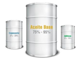
**Aditivos:** Se seleccionan muchos tipos diferentes de aditivos para impartir propiedades específicas al producto terminado, lo que limita los efectos de condiciones adversas tales como cargas pesadas de choque, desgaste, óxido, corrosión y oxidación.
